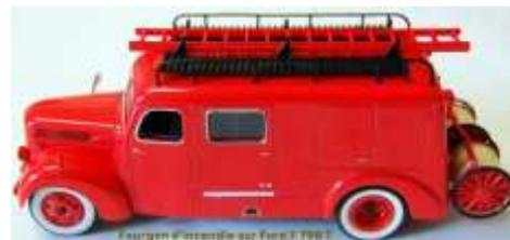
Ce fourgon, premier véhicule du centre, ne possède pas de citerne, mais sa vaste double cabine permet le transport de 12 personnes, et ses coffres abritent les tuyaux et tout le matériel nécessaire aux établissements des lances. Un coffre à l'arrière abrite une moto-pompe-portative, et il tracte la moto-pompe SAMDI.
